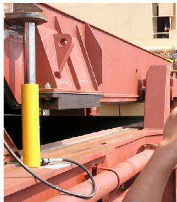
Hình 2: Bố trí kích nâng nắp miệng hầm hàng kiểu pontoon
